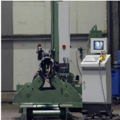
*Die Innenschweißanlage in Aktion: Am Multi Panel Simatic MP 377 kann der Bediener alle Funktionen des Schweißgeräts einstellen – Einrichtung und Seitenführung des Schweißkopfs erfolgen über den Joystick.*
