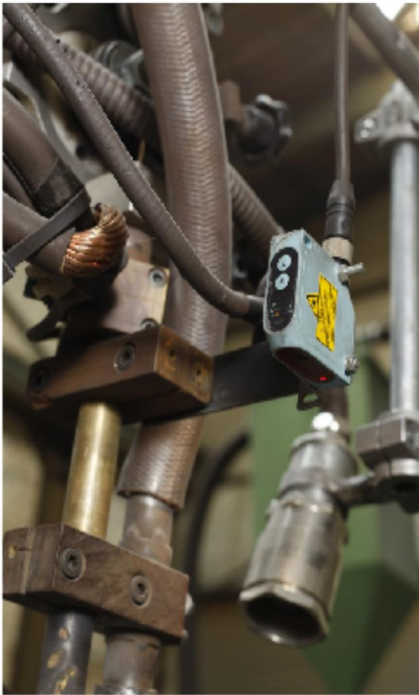
*Auch für das Außenschweißen: Der LH50F advanced arbeitet in sicherer Entfernung vom Lichtbogen in einem Fenster von 80 bis 300 mm.*
